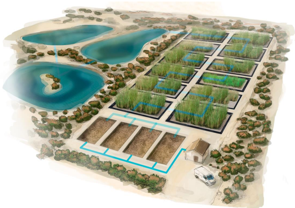
Figura 8.- Esquema genérico de un Filtro Verde
